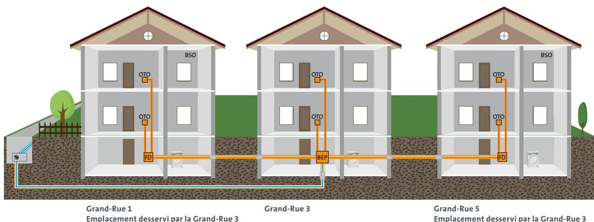
Figure 4: exemple de multiples bâtiments indépendants dotés d'une structure de desserte BSO et équipés de distributeurs intermédiaires ou de distributeurs d'étage
