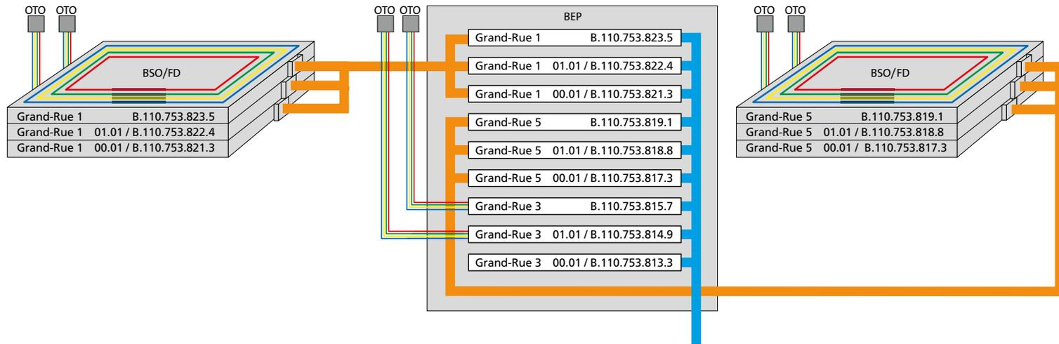
Figure 7: schéma de principe d'un emplacement desservi (BSO) avec distributeur d'immeuble FD et étiquetage des cassettes
