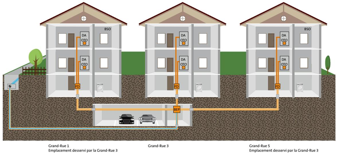
Figure 14: structure de câblage point-à-point (P2P) avec BEP central et distributeurs intermédiaires (DI)
